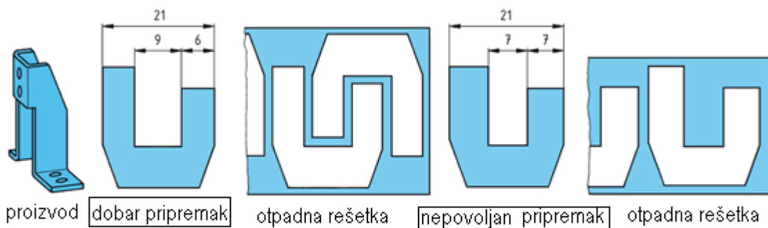
Sl.4: Prikaz dobrog i nepovoljnog priprema za povoljno iskorištenje materijala trake
