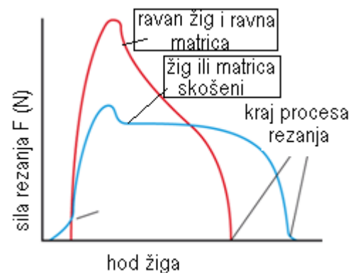
SI.3: Utjecaj skošenja na silu rezanja
