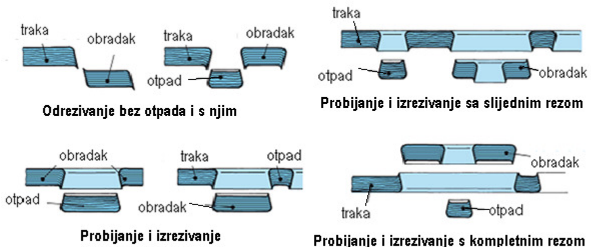
Sl.4: Položaj srha ovisno o postupku rezanja
