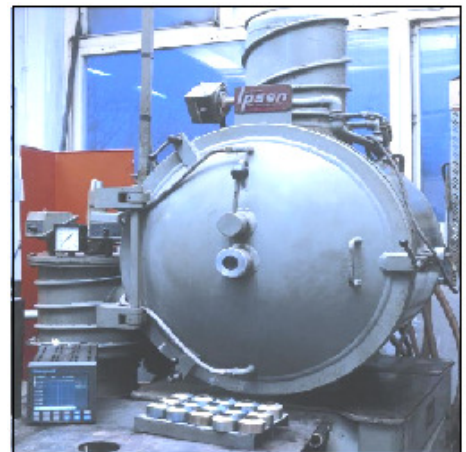
SI.1: Vakuumska peć za kaljenje alatnih čelika
